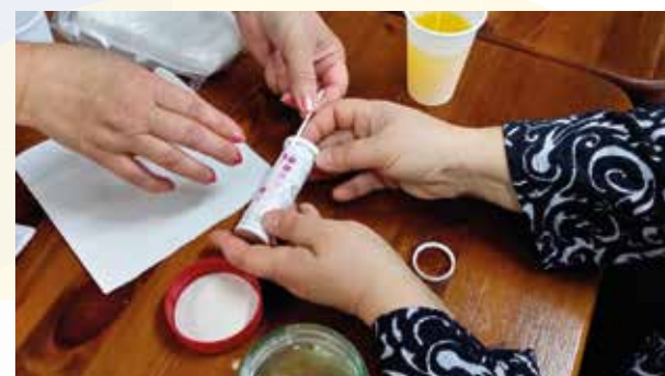
Измерване нитрати и нитрити в подземни води
